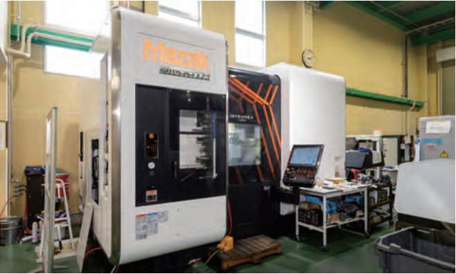
設備名 複合加工機(5軸)インテグレックス 型式 i-200 メーカー マザック 加工可能寸法 φ658*1011L
