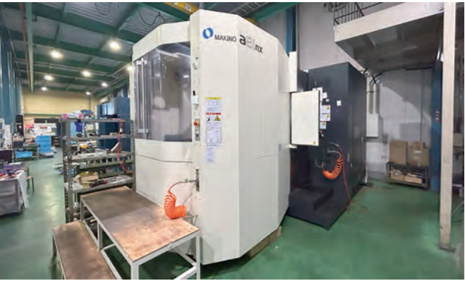
設備名 横型マシニングセンター 型式 a81nx メーカー 牧野フライス 加工可能寸法 900*900*1020
