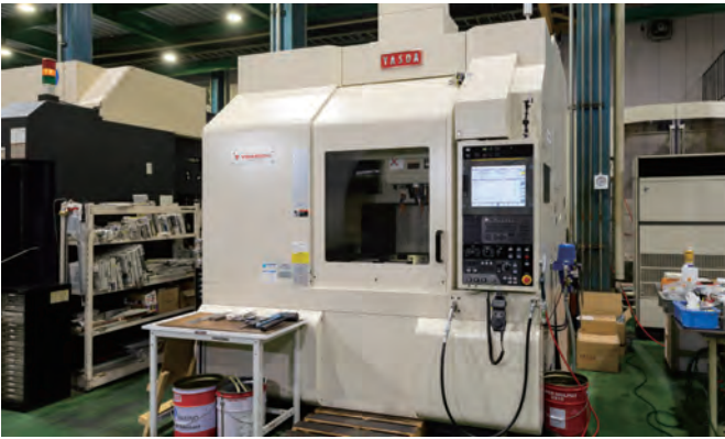
設備名 立形マシニングセンター 型式 YBM950V メーカー YASDA 加工可能寸法 900*500*350
