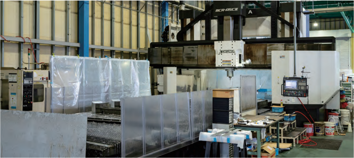
設備名 五面加工機 型式 MCR-A5C II メーカー OKUMA 加工可能寸法 6000*2500*800
