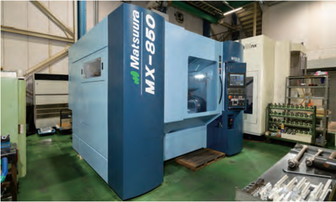
設備名 立形マシニングセンター(5軸) 型式 MX-850 メーカー 松浦機械 加工可能寸法 900*780*650
